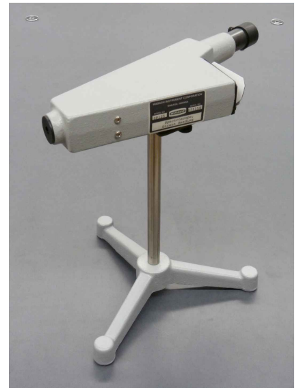
fig. 4 Spectroscopie ou spectromètre, il permet de décomposer un spectre de lumière en séparant de manière très précise les couleurs à l'aide d'un réseau optique interne. Ainsi, les couleurs observées sont réparties le long d'une échelle graduée à laquelle correspond une fréquence.
